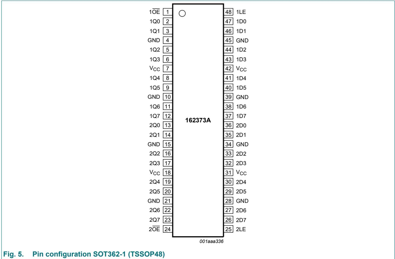
Fig. 5. Pin configuration SOT362-1 (TSSOP48)
