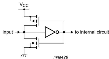
Fig. 4. Bus hold circuit
